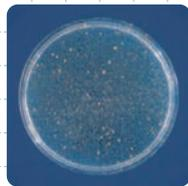
**試験方法** JIS L1902定量試験(菌液吸収法)
